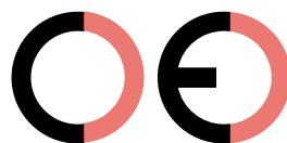
Marcatura CE contraffatta (troppo distante)
